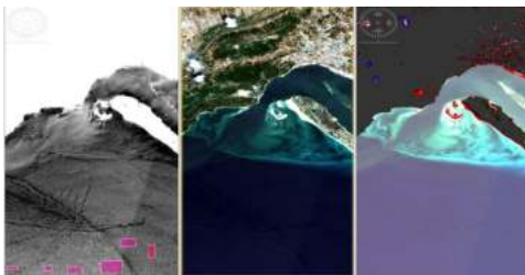
Fig. 2. Banda espectral B8 (NIR) onde se observa o brilho solar na superfície da água; os polígonos representam as regiões selecionadas com brilho solar (Esq.). Imagem original RGB (centro). Imagem RGB sem brilho solar (DTO).
