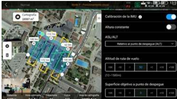
Fig.3 Esquema de la planificación de un vuelo fotogramétrico.
