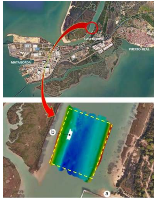
Fig. 2. Imagen superpuesta sobre Google Earth del polígono de trabajo (trazo amarillo). En mapa de colores se observan los resultados de la batimetría multihaz realizada por el USV. (a) indica la ubicación de sondas estaciones de control, y (b) una zona que no fue sondada debido a la presencia de una embarcación fondeada durante la operación.
