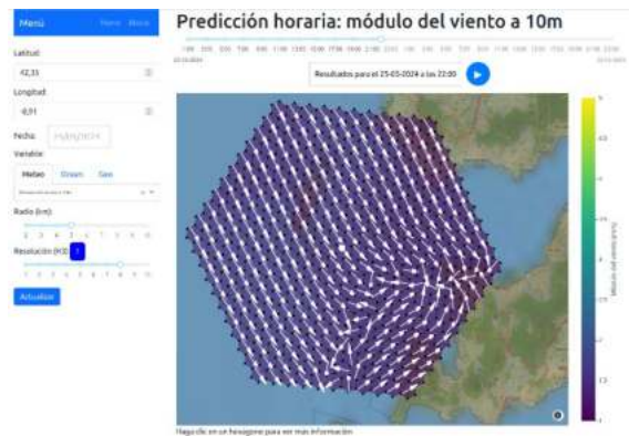
Fig. 3. Predicción del módulo del viento, tomado del modelo WRF de 1Km de MeteoGalicia para la Rias Baixas del día 25/05/2024 para radio de 5km y resolución 8 de H3.
