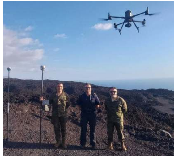
Fig.4 Personal midiendo puntos de apoyo.
