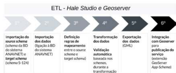
Fig. 2. Etapas do processo de ETL realizadas nos softwares Hale Studio e Geoserver .
