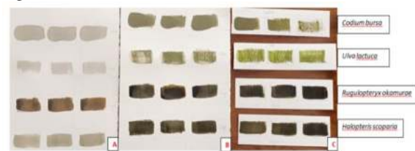
Figura 4. Diferencias de color de los pigmentos algales. A) Después de someterse a dos semanas de envejecimiento. B) Después de dos semanas al exterior. C) Control, tras someterse a dos semanas en cámara de oscuridad.
